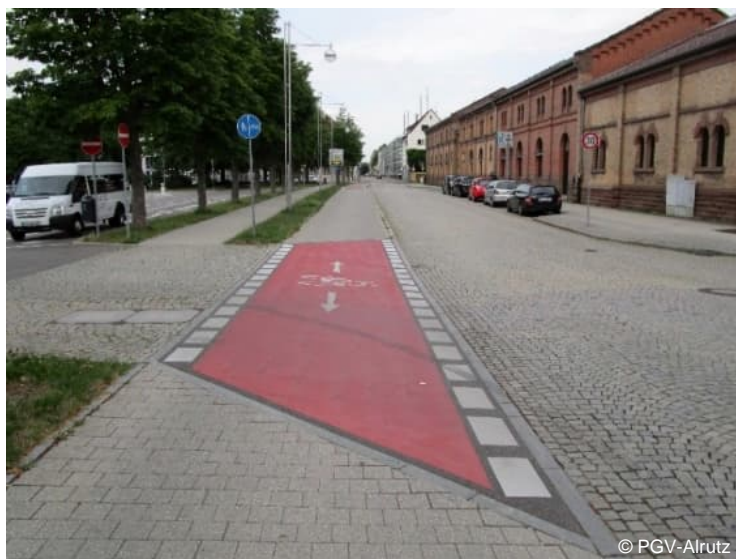
Zweirichtungsrادweg mit deutlich markierter Radverkehrsfurt
