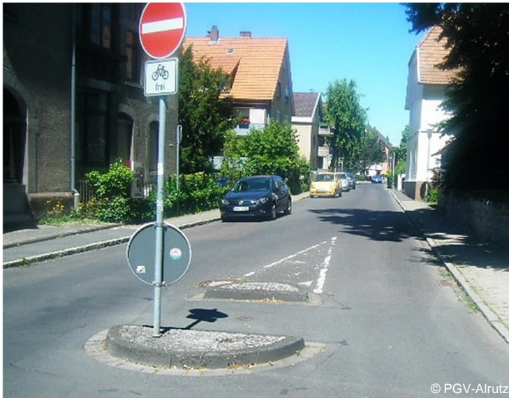
Zugelassener Radverkehr gegen Einbahnrichtung mit „Einfahrtpforte“
