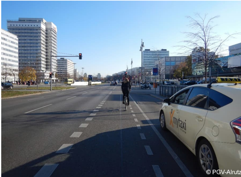
Schutzstreifen mit Sicherheitsraum zu parkenden Kfz
