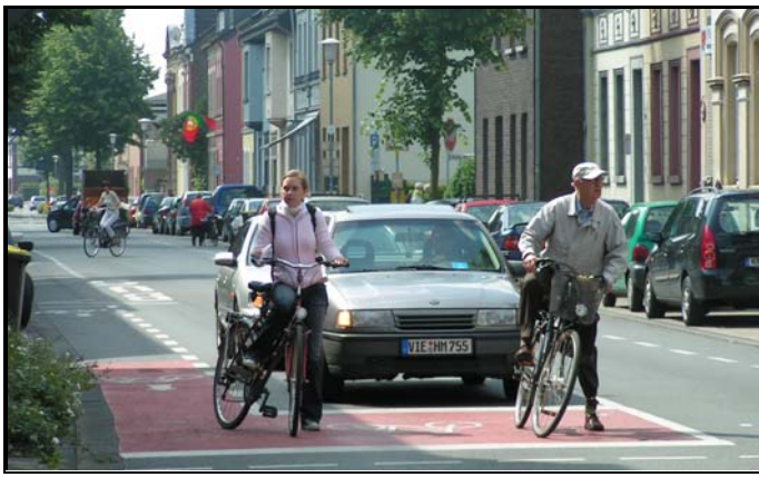
Bild 23: Rot eingefärbter aufgeweiteter Radaufstellstreifen mit vorgelagertem Schutzstreifen
