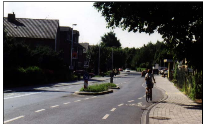
Bild 27: Durchgeführter Schutzstreifen im Bereich einer Mittelinsel
