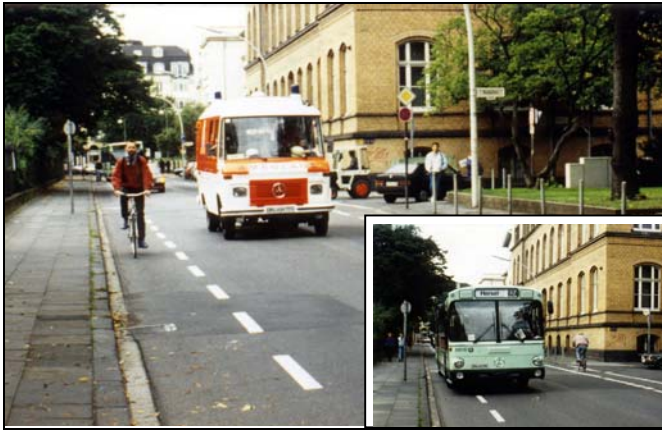
Bild 1: Schutzstreifen als Schonraum für Radfahrer und als "Reservefläche" für große Fahrzeuge
